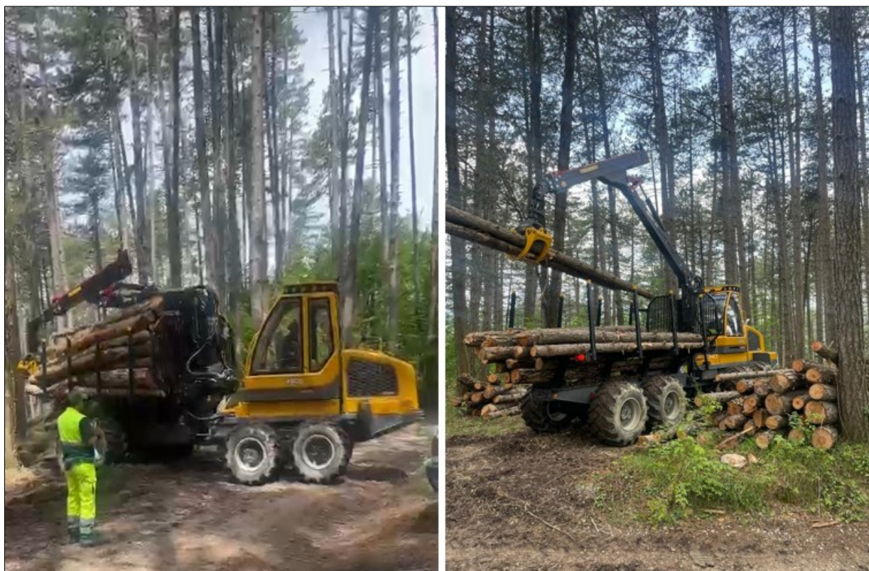
Foto 7 - Esbosco del legname con forwarder nell'ambito di un intervento di diradamento di un bosco di conifere a dominanza di pino nero
